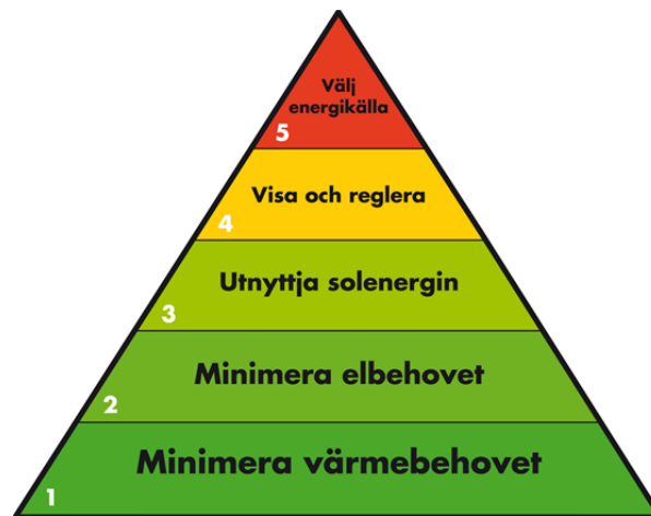
FIGUR 2:4 KYOTOPYRAMIDEN SOM ARBETSSÄTT I PROJEKTERING AV LÅGENERGIHUS (KÄLLA: WWW.SINTEF.NO)
